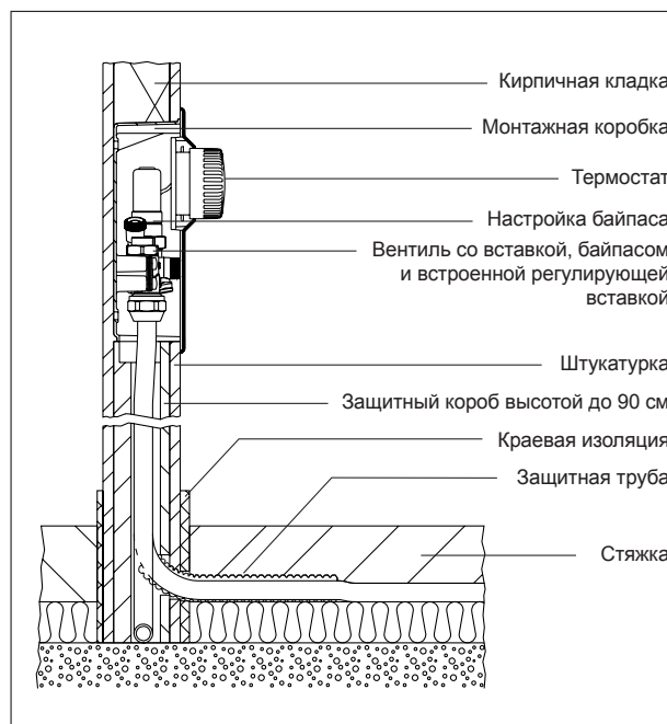
Пример установки „Unibox E BV“ в стене
