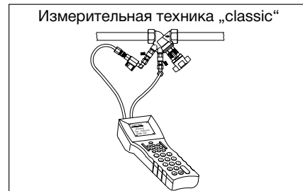
Регулирование на вентиле „Hydrocontrol VTR“
