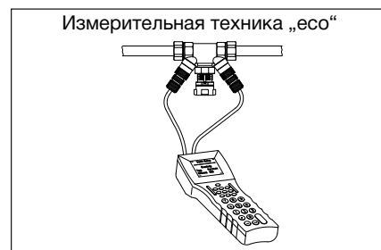
Регулирование на вентиле „Нусосон VTZ“
