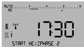
Abbildung 52: Display-Anzeige Startpunkt HEIZPHASE 2
