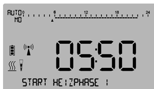
Abbildung 48: Display-Anzeige Startpunkt HEIZPHASE 1
