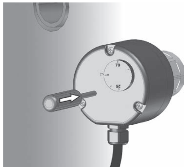
Abbildung 17: Entriegelung mit Schraubenzieher
