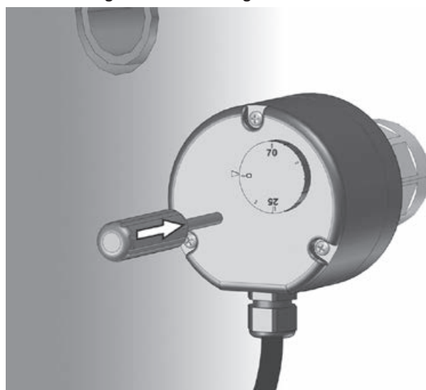
Figure 17: Déblocage à l'aide d'un tournevis
