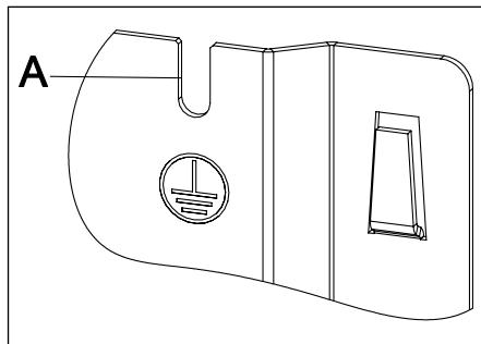
Fig. 7.1 Collegamento equipotenziale di protezione / Messa a terra
