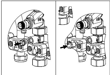
Fig. 6.3 Montage du bouchon
