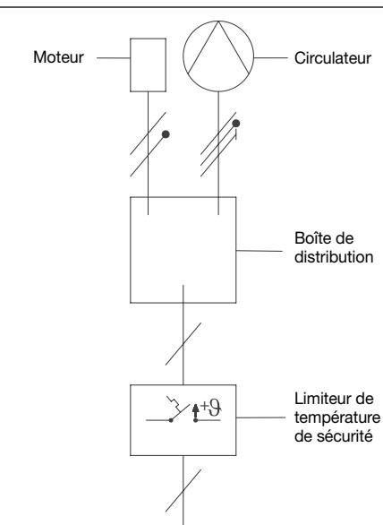
Fig. 4.1 Schéma d'installation câblage
