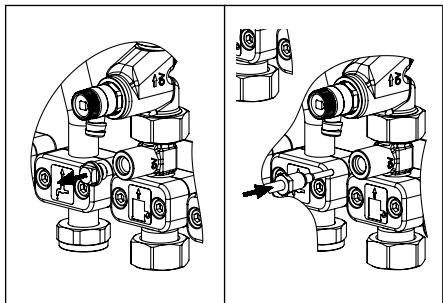
Fig. 6.3 Montaggio tappi
