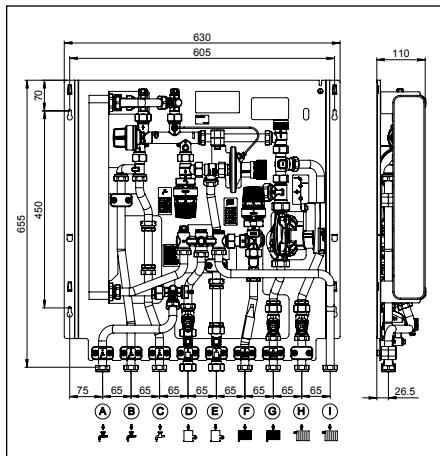
Fig. 4.2 Encombrements avec circuit à haute température
