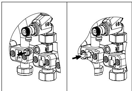
Abb. 6.4 Einbau Fühler für Wärmezähler
