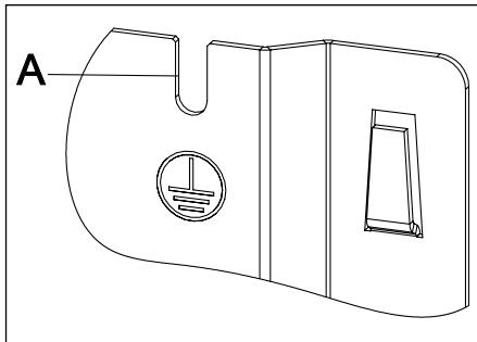
Abb. 7.1 Schutzzpotentialausgleich/Erdung
