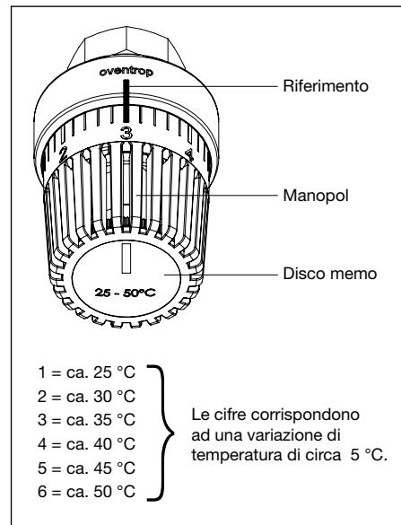
Fig. 8.4 Impostazione temperatura manda circuito di riscaldamento
