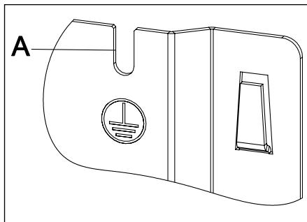
Fig.7.1 Protection équipotentielle / mise à la terre
