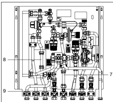
Fig. 6.3 Montaggio contatore acqua fredda e contacalorie
