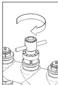
4. Régler la flèche de la bague de réglage sur le marquage de la clé de préréglage.
