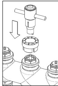
3. Fermer le bypass en tournant la tige bypass dans le sens des aiguilles d'une montre.
