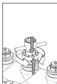
5. Le réglage est effectué en tournant la clé contre le sens des aiguilles d'une montre (un tour complet correspond au préréglage 1 etc., 6 tours au maximum).
