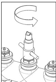
2. Aufsetzen von Einstellring und Voreinstellschlüssel.
