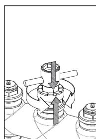
5. Die Einstellung erfolgt durch drehen gegen den Uhrzeigersinn (eine volle Umdrehung entspricht der Voreinstellung 1 usw., max. 6 Umdrehungen).
