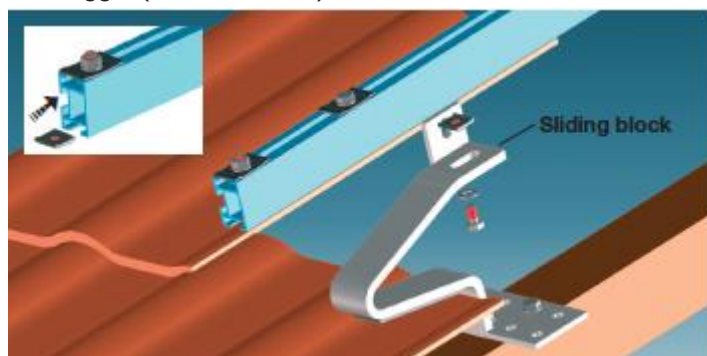
Illustr. 7: Fissaggio delle guide di montaggio
