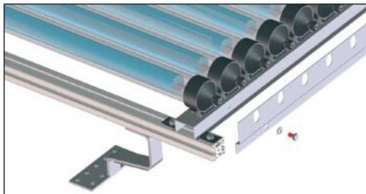
Illustr. 25: Installazione della lamina a gomito nella parte inferiore della guida al piede
