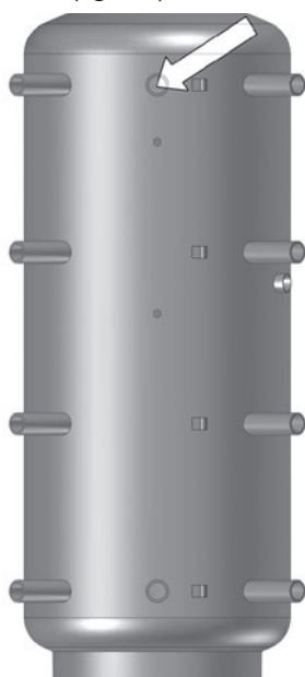
fig. 4.7: Posición de la conexión del tubo “circuito acumulador - ida” de la estación de agua potable al acumulador
