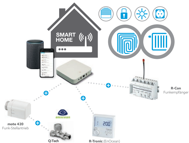
Abb. 1: Automatisch Voreinstellen und Abgleichen mit der wibutler pro-Zentrale und Q-Tech
