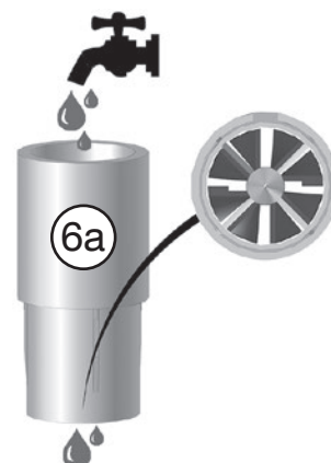
Abb. 5.18: Messturbine unter fließendem Wasser reinigen
